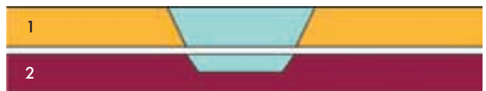
Рис. 5. Схема вставки из мягкого материала в толще стельки (1) и подошвы обуви (2).
